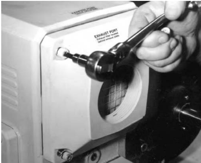
Obr. č. 3 - Odstraňovanie výfukovej skrine
