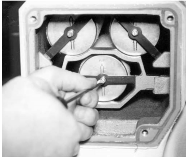
Obr. č. 4 - Odstraňovanie pružinovej príchytky filtra
